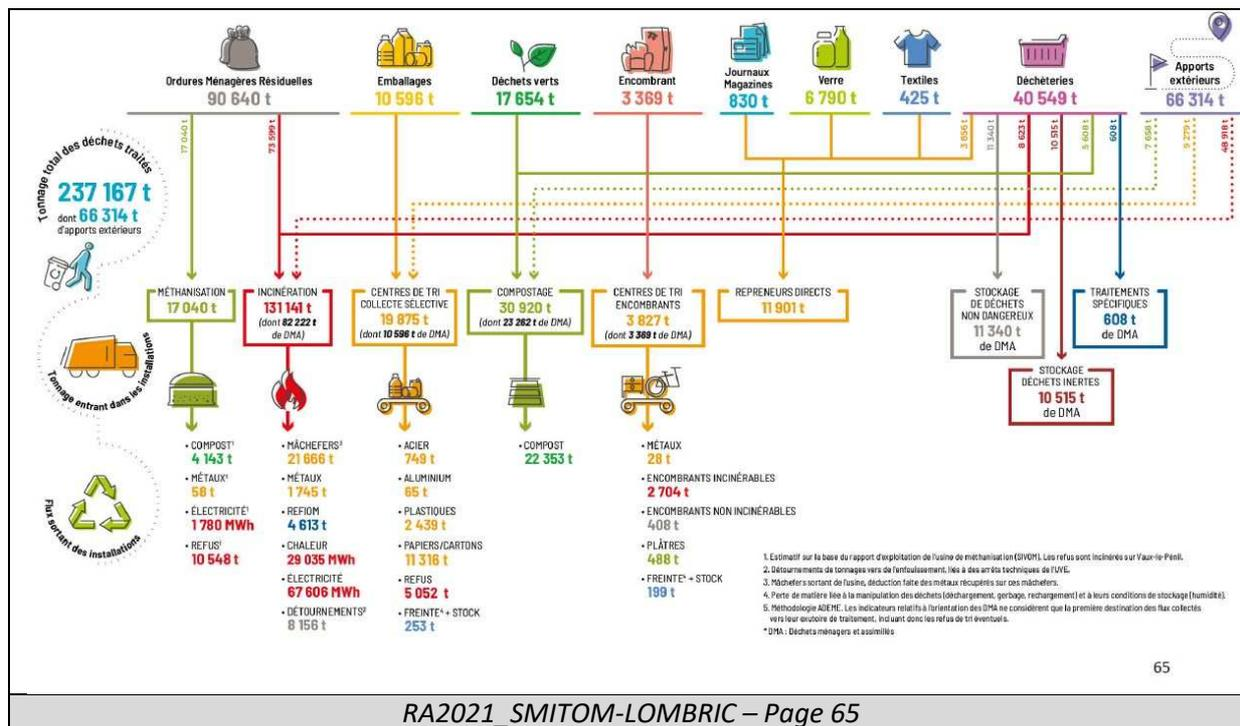
Pour les OMR, ce synoptique indique une collecte **90 640 tonnes**, dont **17 040 tonnes** sont traités en méthanisation et **73 599 tonnes** sont incinérées.
